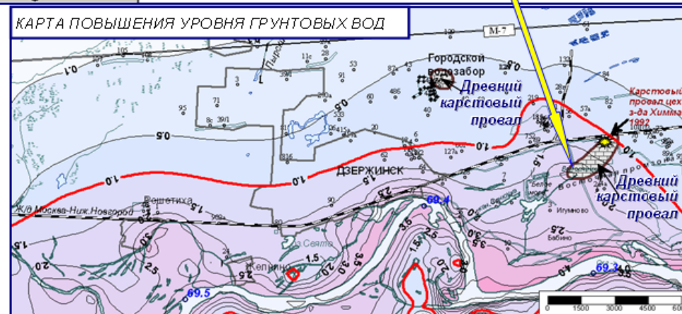
Рис.13 Разгрузка напорных подземных вод казанского горизонта на участке активного древнего карстового провала в районе накопителя «Белое море»
